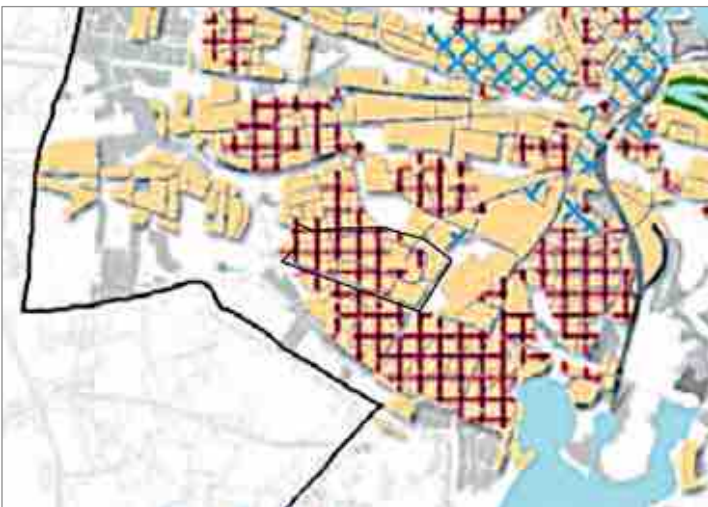
10 Maßnahmenplan Gewässerqualität und Starkregen (im Gebiet: gelb: dezentrale Regenwasserbewirtschaftung ausweiten, weinrote Kreuze: Versickerungspotentiale vorrangig ausschöpfen)
