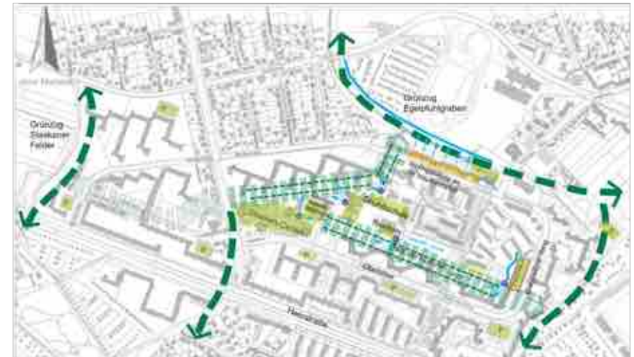
Abb. Regenwassermanagement: Versickerungsmulden und Mulden-Rigolensystem auf den Hauptwegeachsen (Hauptpromenaden)
